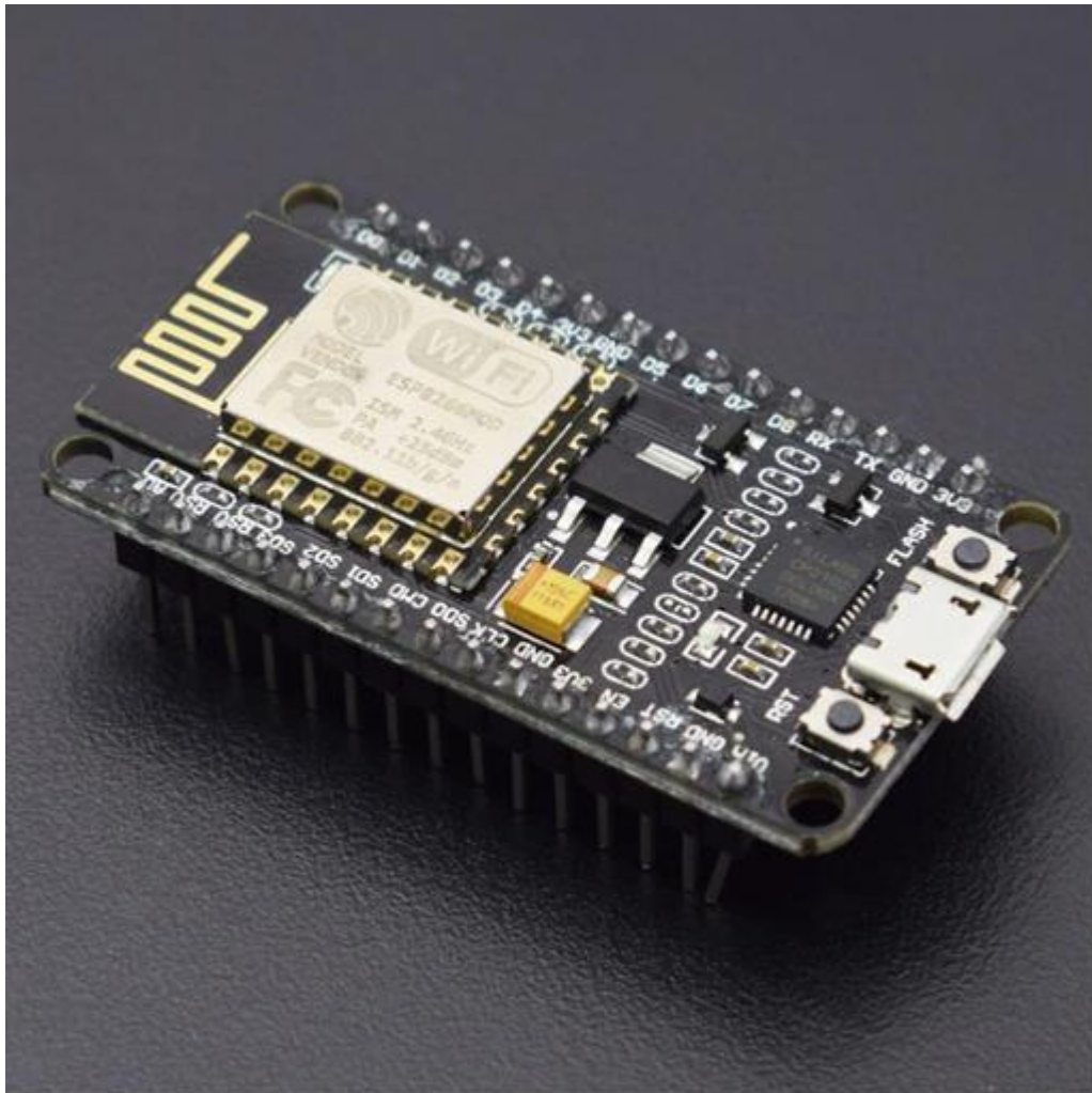
Рис. 1.6. Мікроконтролер ESP8266
