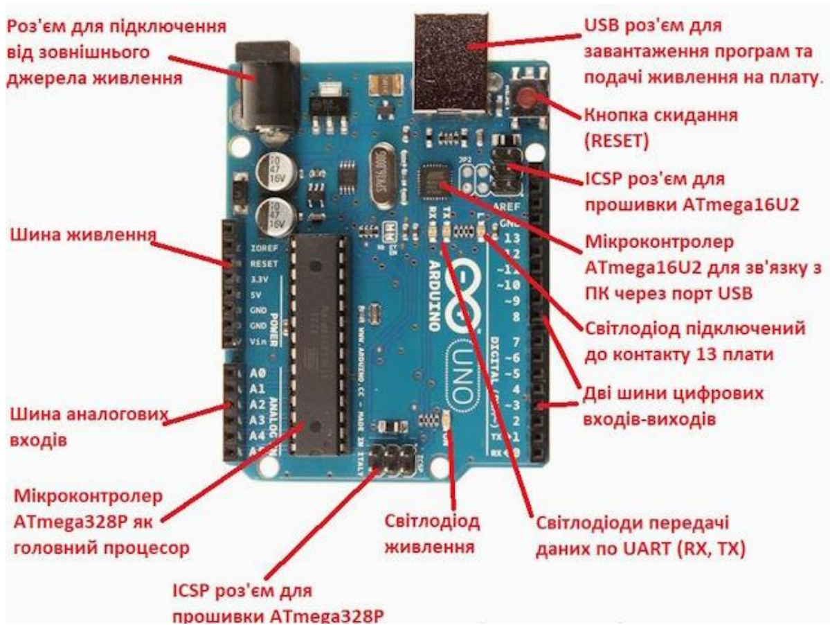
Рис. 2.3. Виводи Arduino UNO
