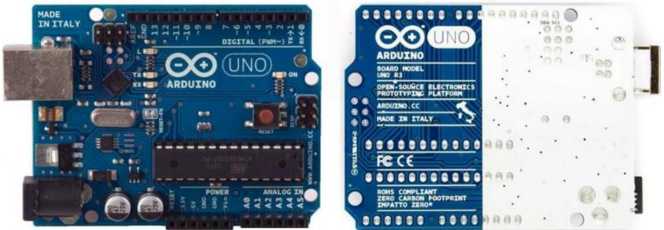
Рис. 2.1. Плата Arduino UNO
