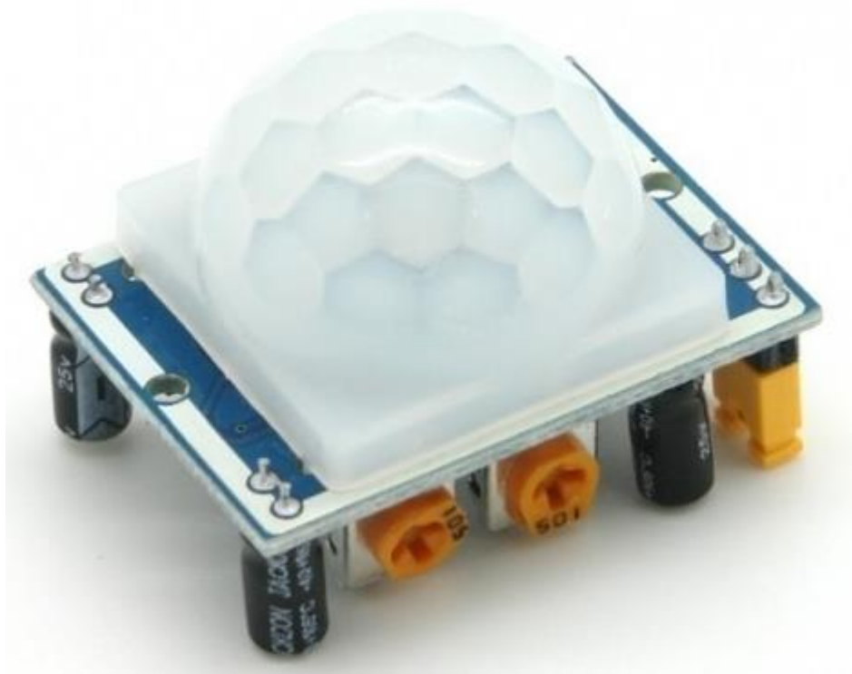
Рис. 2.7. PIR-датчик
